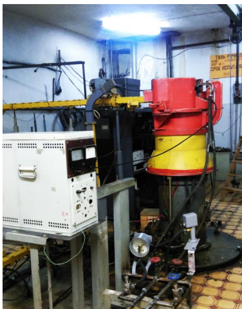
Слева третий клистронный пост после восстановления. Справа тракт параллельного переноса (в синхротронном зале)
