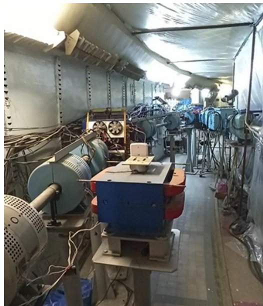
Слева третий клистронный пост после восстановления. Справа тракт параллельного переноса (в синхротронном зале)
